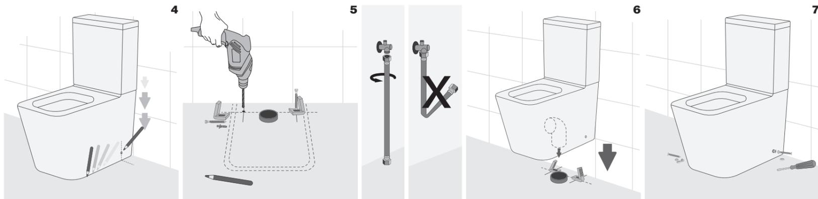
Efetuar algumas descargas de água de forma a verificar o bom funcionamento e detetar eventuais fugas de água nas ligações, após todo o sistema montado.
